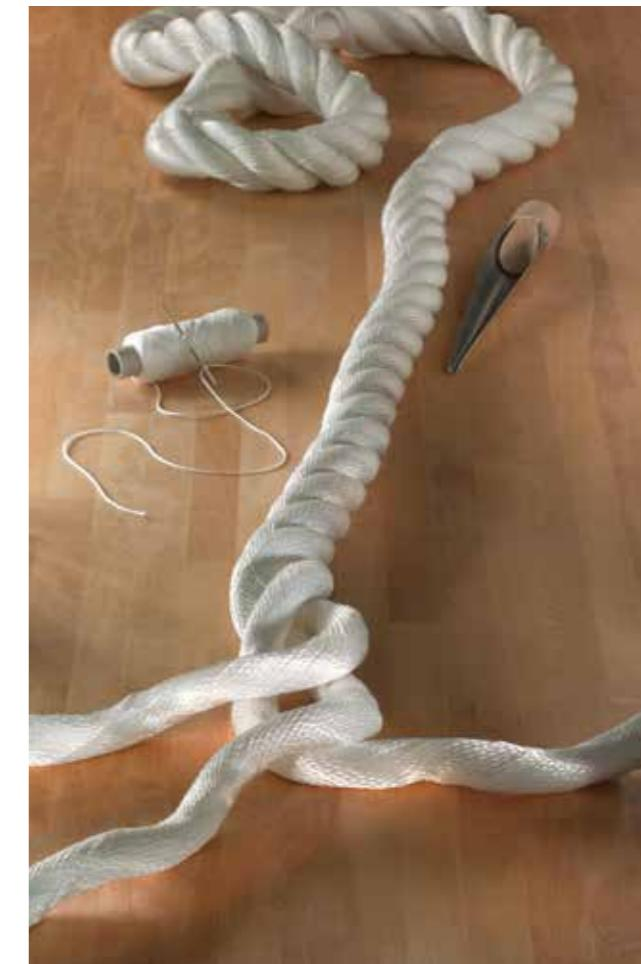
**Twist:** gedrehtes Seil / Laid (twisted) rope
